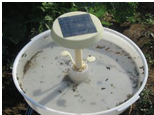
شکل ۴۵- تله نوری که در روز با نور خورشید شارژ می‌شود و شب روشن شده و شب‌پره‌ها را شکار می‌کند.
