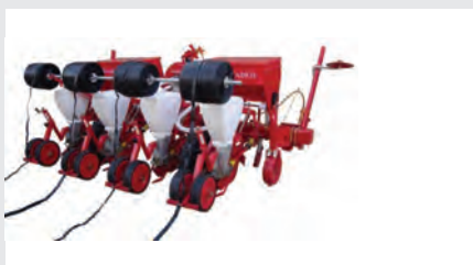
شکل ۱۴- استقرار نوار تیپ با ماشین کاشت
