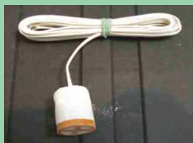
شکل ۵- نمونه بلوک گچی استوانه‌ای
