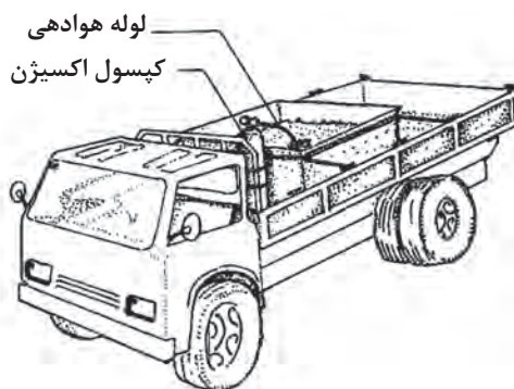
ماشین حمل‌ونقل ماهی زنده مجهز به کیسول اکسیژن و لوله هواده
