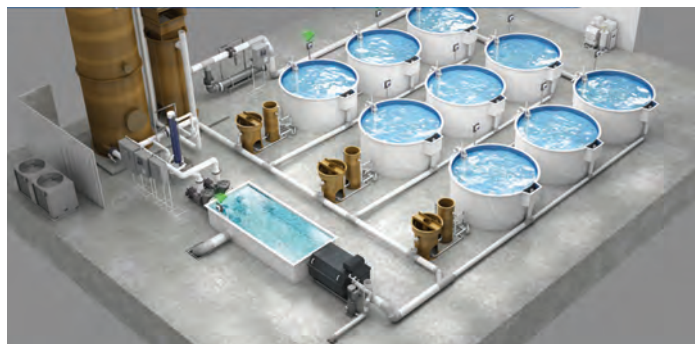
سیستم چرخش آب در پرورش ماهی
