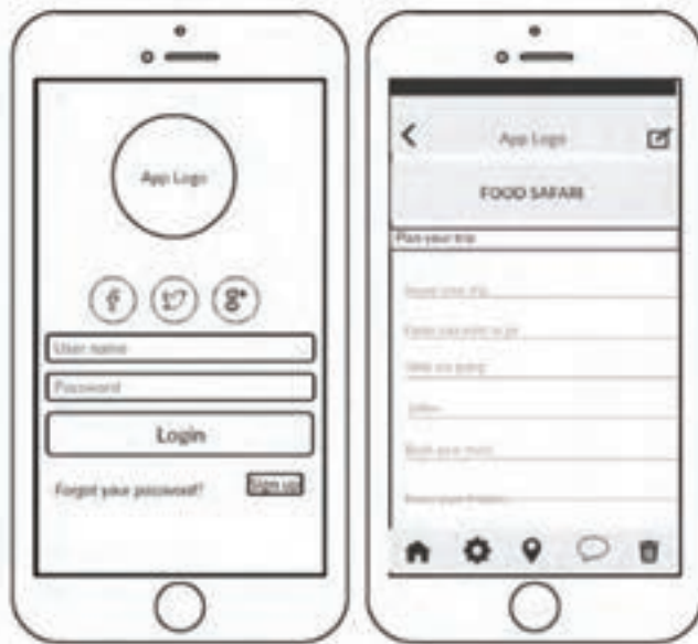
▲ تصویر ۱۲- دو نمونه «وایرفریم» در بالا نمونه «وایرفریم» یک صفحه وب سایت و تصویر پایین «وایرفریم» اپلیکشین
