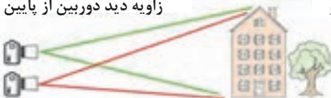
نمایش نحوه تغییر در پرسپکتیو تصویر در اثر تغییر زاویه دید دوربین
