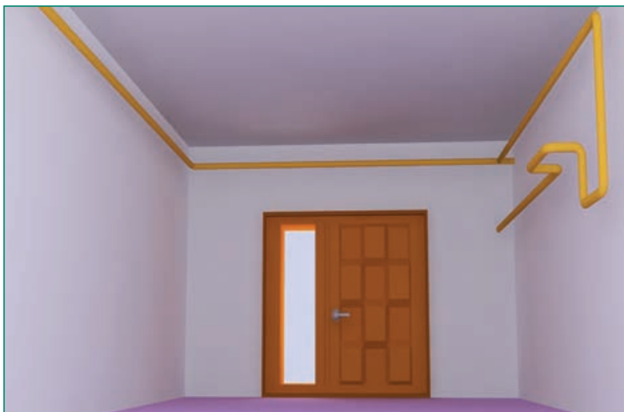
شکل ۴-۲۳ الف نمایش مسیر لوله‌ها در داخل راهرو
