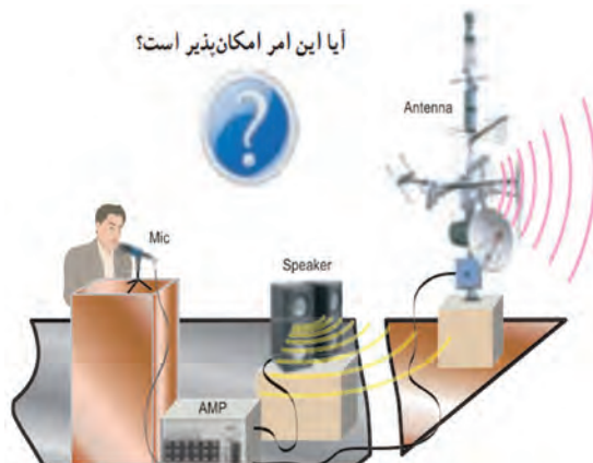
شکل ۶-۴۷ تبدیل امواج صوتی به امواج الکترومغناطیس
