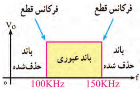
شکل ۵-۶ منحنی پاسخ فرکانسی فیلتر ایده‌آل
