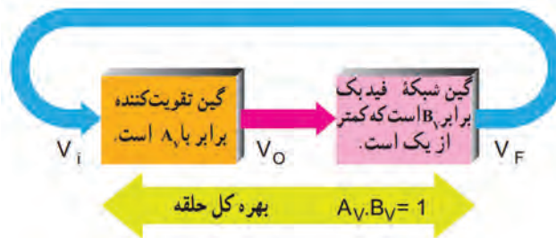
شکل ۶-۳۰ بررسی اصل بارک‌هاوزن
