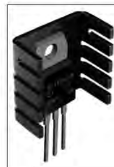
شکل ۷-۶۸ ترایاک متصل شده به گرماگیر
