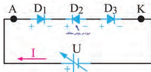
شکل ۷-۴ دیود چهار لایه در بایاس موافق
