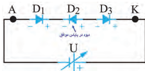
شکل ۷-۵ دیود چهار لایه در بایاس مخالف
