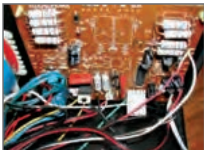
شکل ۹۴- برد الکترونیکی و کنترل شدت هوای فشرده
