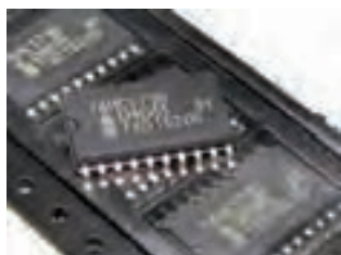
شکل ۱۰۸ - تصویر ظاهری انواع پکیج‌ها SOIC
