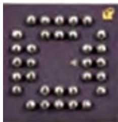
شکل ۱۱۱ - تصویر ظاهری انواع پکیج‌های BGA
