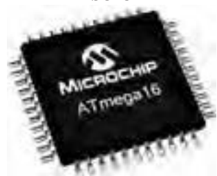
شکل ۱۰۹ - تصویر ظاهری انواع پکیج‌های QFP
