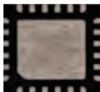
شکل ۱۱۰ - تصویر ظاهری انواع پکیج‌های DFN، TDFN
