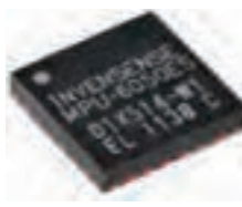
شکل ۱۱۰ - تصویر ظاهری انواع پکیج‌های DFN، TDFN
