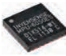
شکل ۱۱۰ - تصویر ظاهری انواع پکیج‌های TDFN, DFN
