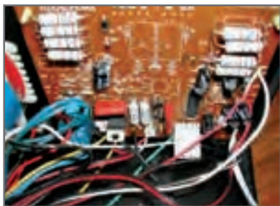
شکل ۹۴- برد الکترونیکی و کنترل شدت هوای فشرده
