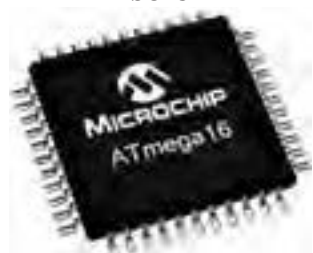
شکل ۱۰۹ - تصویر ظاهری انواع پکیج‌های QFP
