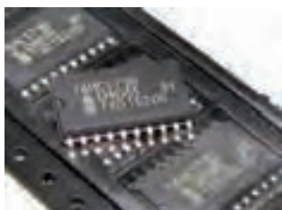
شکل ۱۰۸ - تصویر ظاهری انواع پکیج‌ها SOIC
