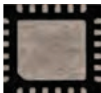
شکل ۱۱۰ - تصویر ظاهری انواع پکیج‌های TDFN, DFN
