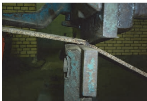
شکل ۳۰- شکست قطعه در انتهای برش کاری
