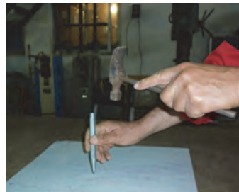
شکل ۱۳- استفاده از سنبه برای نشانه‌گذاری
