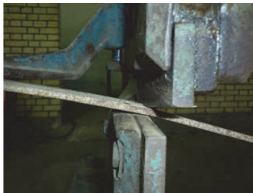
شکل ۲۸- ایجاد شیار آغازین در قطعه
