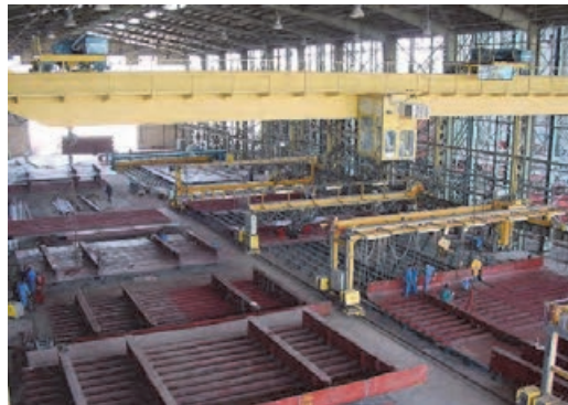
شکل ۴- اسمبل کردن بلوک کشتی
