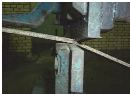
شکل ۲۹- نفوذ تیغه‌ها در قطعه
