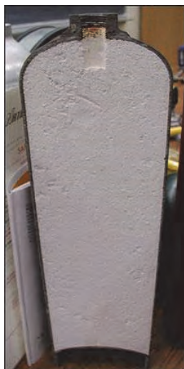
شکل ۷- کیسول برش خورده استیلن
