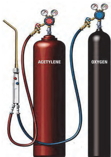
شکل ۲۹- یک واحد جوش کاری گاز
