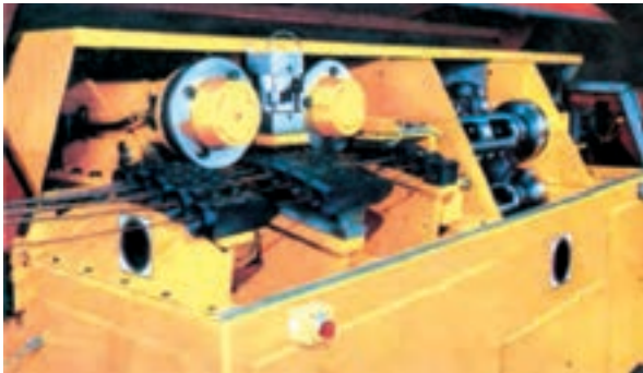
دستگاه کشش برقی برای صاف کردن میلگرد
