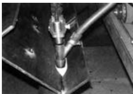
جوشکاری زیر پودری
