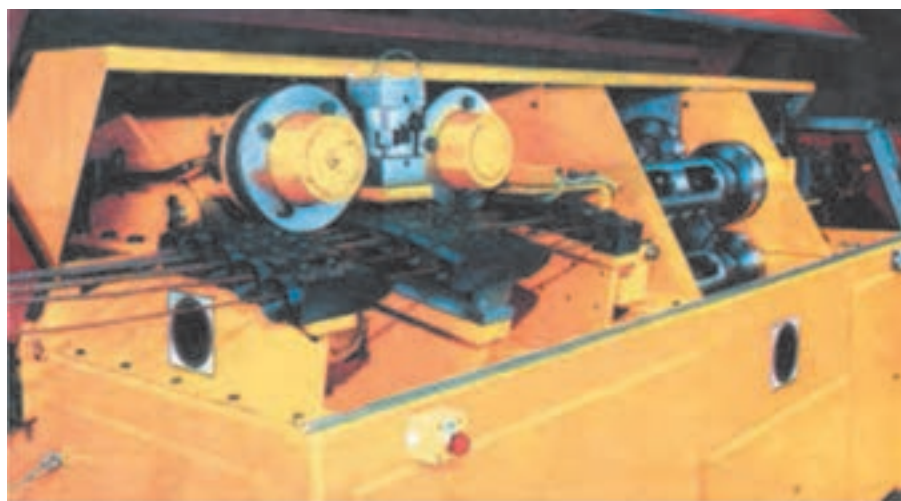
شکل ۲۹ - دستگاه کشش برقی برای صاف کردن میلگرد ▲
