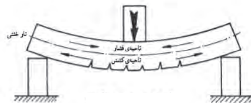
شکل ۱-۱۴ - تیر بتنی پس از بارگذاری ▲
