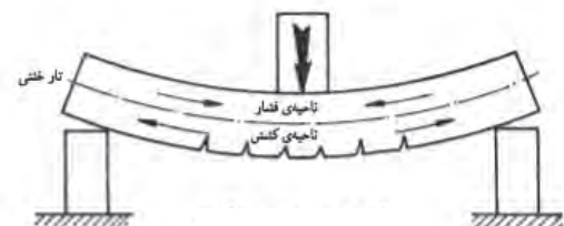
شکل ۱۴-۱ - تیر بتنی پس از بارگذاری ▲
