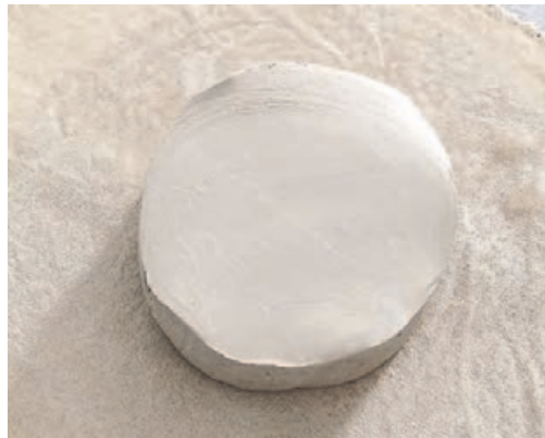
شکل ۹- گل پلاستیک مورد استفاده در روش جیگر و جولی
