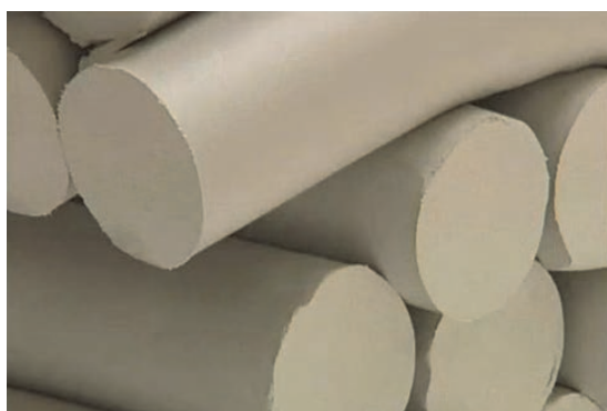
شکل ۸- اکستروود کردن گل پلاستیک
