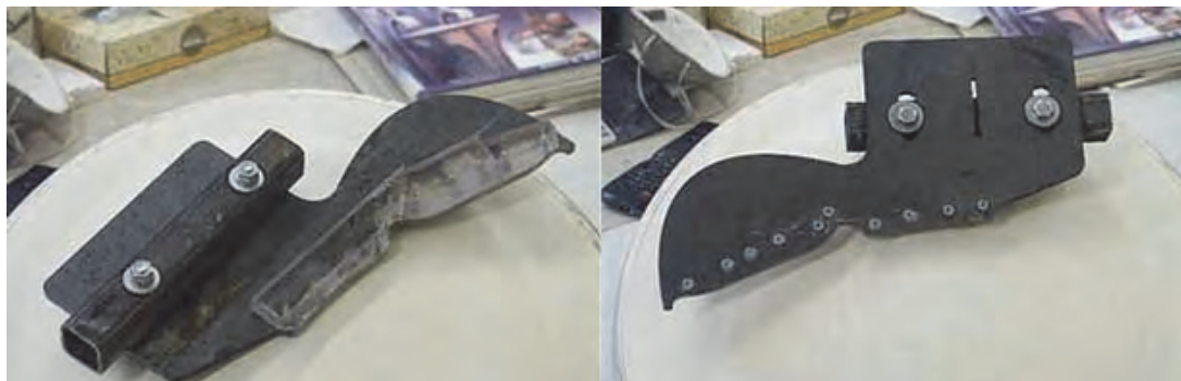
شکل ۲۰- شابلون با پیچ و مهره قابل تنظیم
