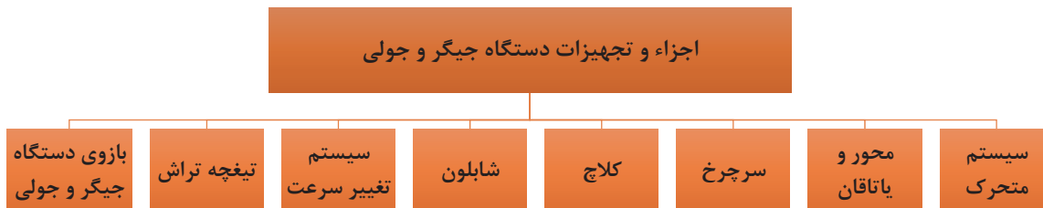
شکل ۱۴- اجزا و تجهیزات دستگاه جیگر و جولی
