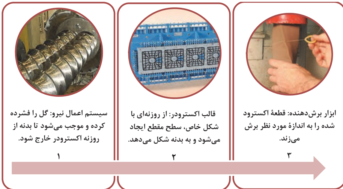
شکل ۶- اجزاء ماشین اکسترودر
