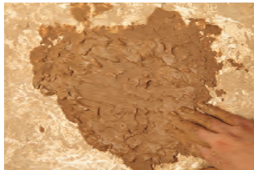
شکل ۱۱- تهیه گل یکنواخت با دوغاب
