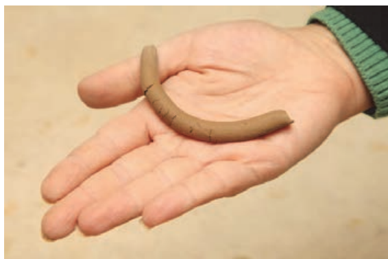
شکل ۱۵- بررسی فتيله در روش آتبرگ
