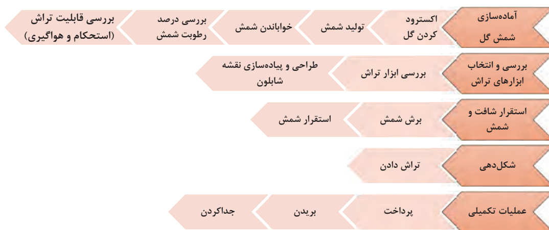
شکل ۷- مراحل شکل‌دهی گل پلاستیک به روش تراش
