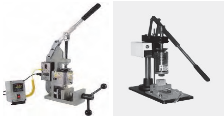
شکل ۲۱- دستگاه نیمه اتوماتیک (دستی) قالبگیری تزریقی
