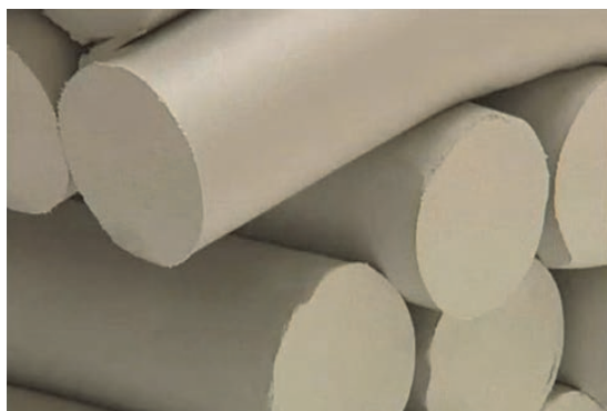
شکل ۸- اکستروود کردن گل پلاستیک
