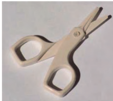
شکل ۲۵- قیچی سرامیکی (آلومینا) شکل‌دهی شده به روش قالبگیری تزریقی
