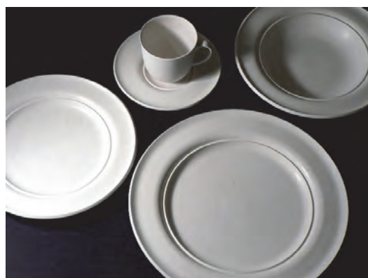
شکل ۵- قطعات تولیدشده به روش جیگر و جولی
