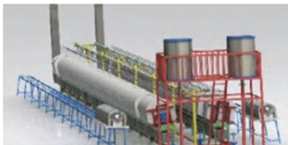
ب) قرار دادن مخزن دوغاب در ارتفاع
