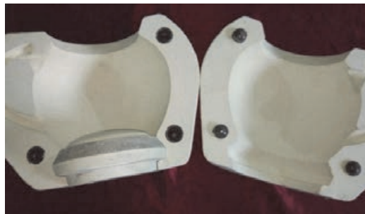
شکل ۲۴- الگوی گچی با زبانه‌های پلاستیکی
