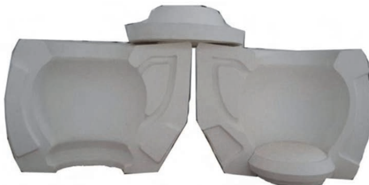
شکل ۲۶- قالب بدنه‌ی یک قوری
