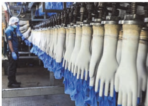
شکل ۱- قالب مورد استفاده در تولید دستکش
