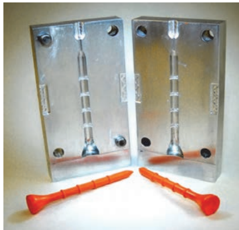
شکل ۳- قالب مورد استفاده در تولید میخ
