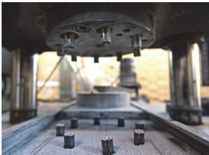
شکل ۱۱- پرس با قالب حاوی ۸ حفره
