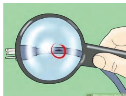
الف) پارگی پوشش سیم تغذیه
