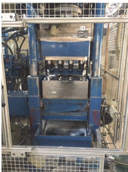
شکل ۱۳- پرس ایزواستاتیک گلوله آلومینایی
