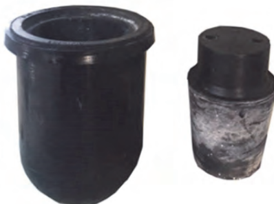
شکل ۱۴- قالب و پانچ پلی یورتانی جهت تولید گلوله
