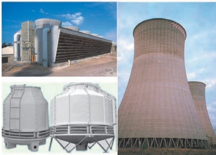
شکل ۸-۲- انواع برج های خنک کننده مرطوب
