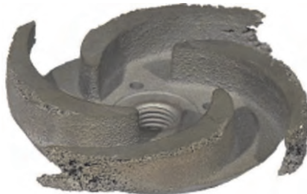
شکل ۱۸-۳ آسیب‌دیدگی پروانه پمپ در اثر پدیده کاویتاسیون
