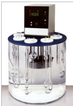
شکل ۱۱-۳- حمام مجهز به کنترل کننده دما
