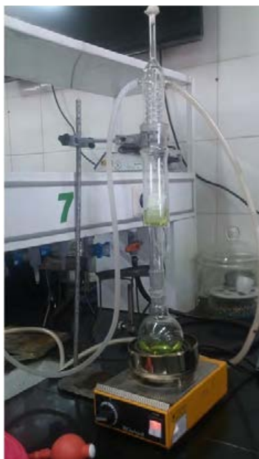
شکل ۱۸-۵ شمای ساده‌ای از سوکسله
