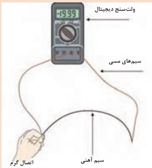
شکل ۲۲- ساخت یک ترموکوپل ساده
