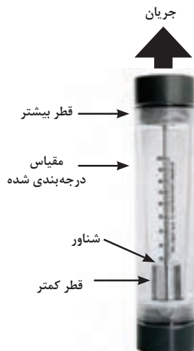
شکل ۷ - یک نمونه روتامتر معمولی
