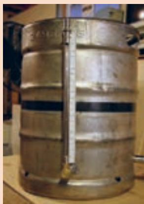
شکل ۲۰- طرح ساده‌ای از فعالیت عملی اندازه‌گیری ارتفاع سطح مایع در کارگاه
