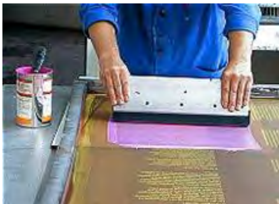
شکل ۶-۴ راکل کشیدن روی توری
