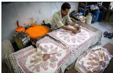
شکل ۵-۱ چاپ به روش نقش بر جسته روی چوب
