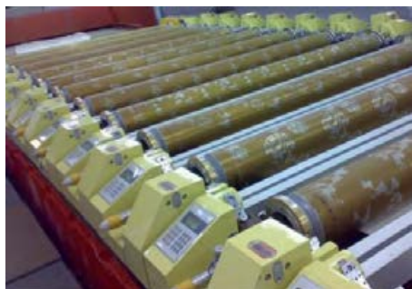
شکل ۷-۱ استفاده از رایانه ها در ماشین چاپ
