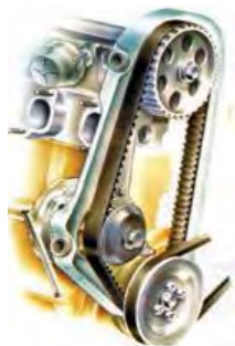
شکل ۲۸-۵ کاربرد چرخ و تسمه در موتور خودرو
