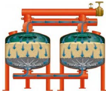
شکل ۶-۶ روش تصفیه شنی و تمیز کردن شن ها
