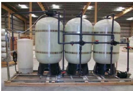
شکل ۶-۸ نمونه یک دستگاه سختی گیر آب است.
