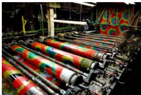
شکل ۲-۴ نمونه چاپ طرح باتیک با ماشین های چاپ
