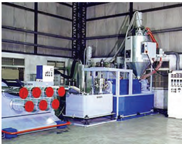
شکل ۱ - دستگاه تولید الیاف پلی‌استر
