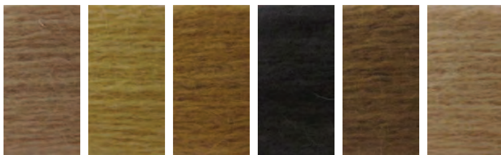
شکل ۶ تصویر پشم رنگریزی شده با برگ مورد با دندانهای مختلف به روش پیش دندان
