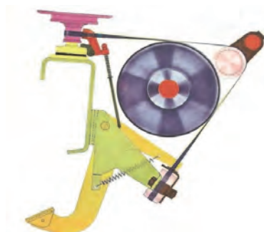
شکل ۲۹ تجهیزات ترمز گرفتن دوک
