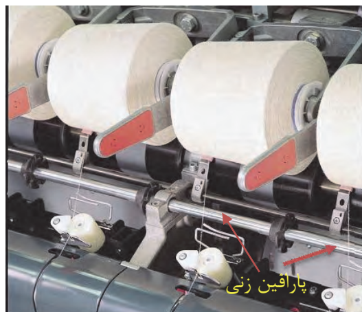
شکل ۳۰ پارافین زدن به نخ
