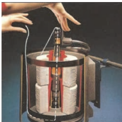
شکل ۲۱ دو بوبین نخ یک لا داخل کاسه
