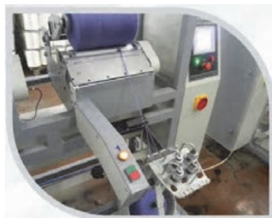
شکل ۴ پولکی‌های کشیدگی نخ
