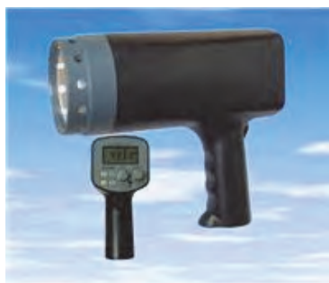
شکل ۳۴ استروسکوپ یا ارتعاش‌سنج
