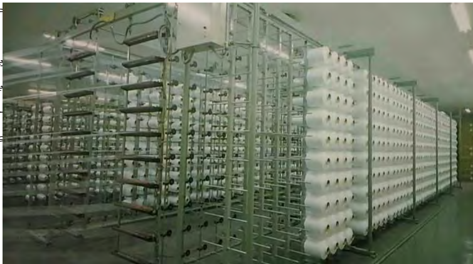
شکل ۴ قفسه ماشین چله پیچی
