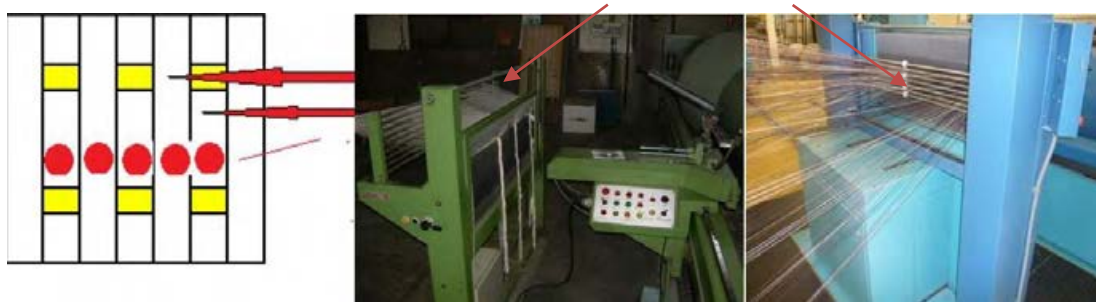
شکل ۱۳ شانه مقسم یا متحرک
