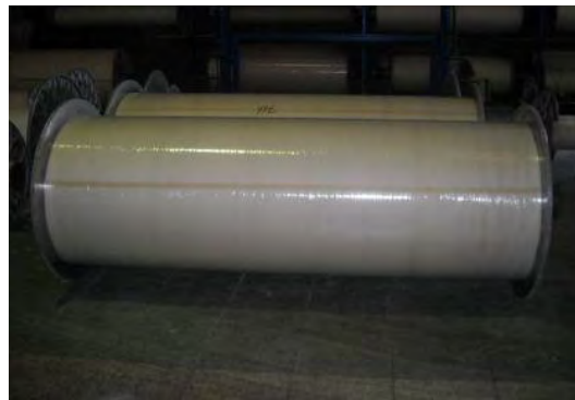
شکل ۲ اسنو پر شده از نخ تار
