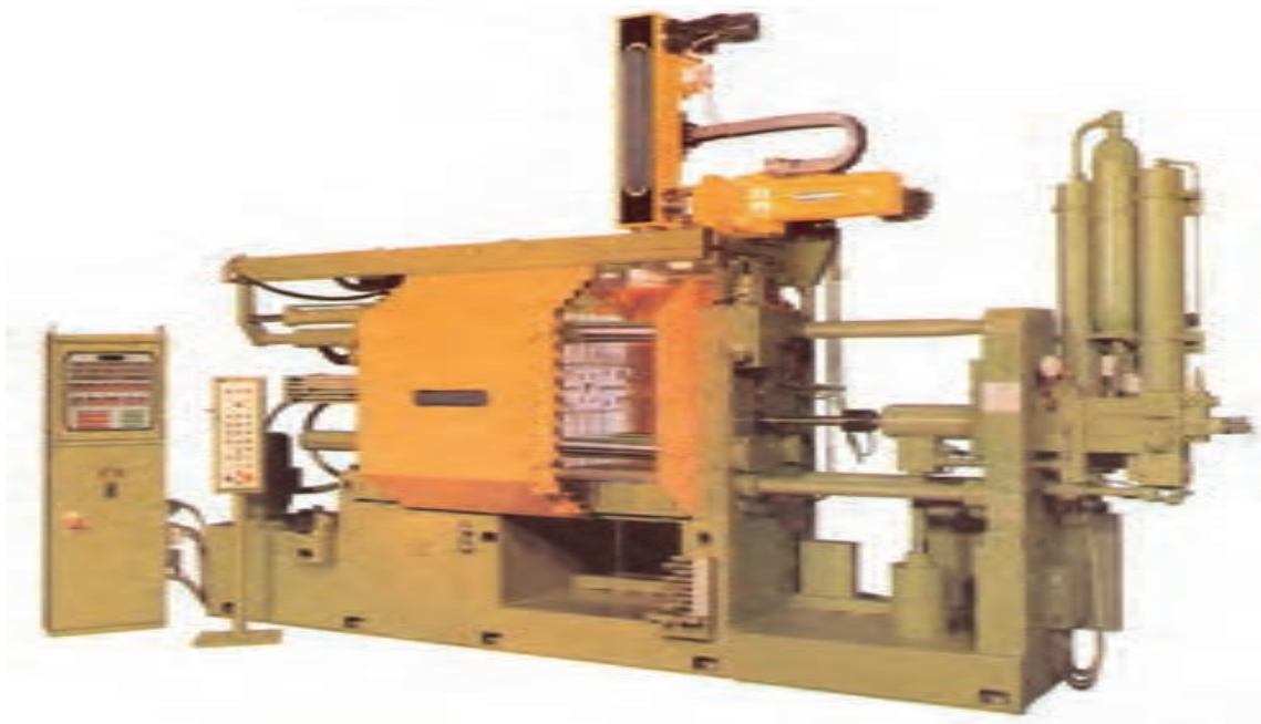
شکل ۲۶-۳- ماشین ریخته‌گری تحت فشار با محفظه سرد
