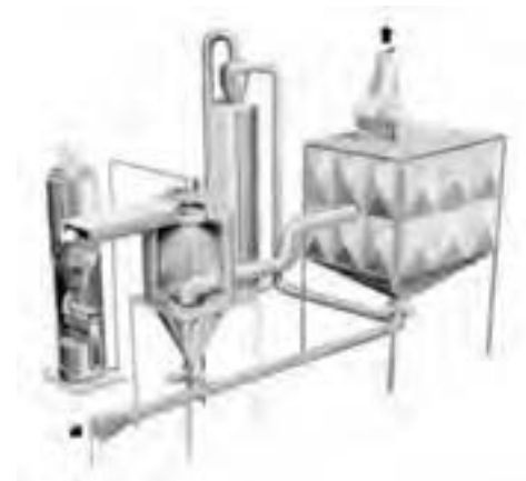
شکل ۳۵-۲- سیستم سایش نیوماتیکی برای احیای ماسه به روش خشک
