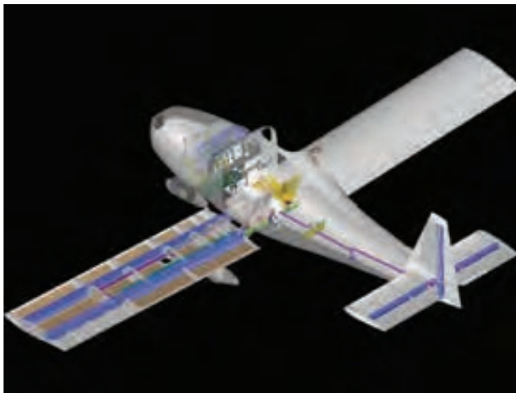
شکل ۲-۲۱- استفاده از مواد کامپوزیتی مستحکم در ساخت قطعات هواپیما موجب کاهش وزن، افزایش سرعت و کاهش مصرف سوخت می‌شود.
