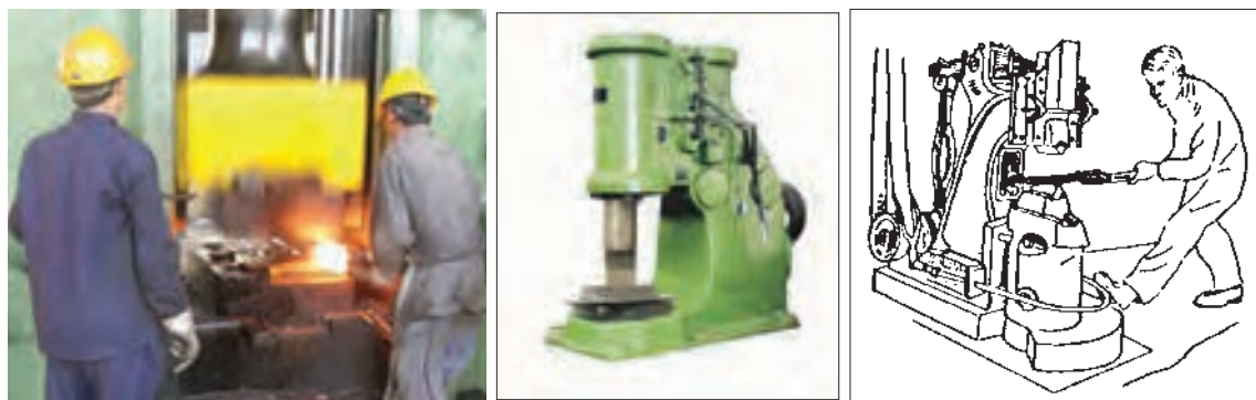
شکل ۱۰-۳- الف) دو نمونه از ماشین‌های پرس یا چکش‌های نیوماتیکی (ب) نمونه‌ای واقعی از یک پرس پتک کاری
