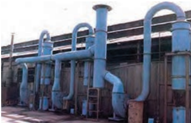
شکل ۳۵-۲- سیستم سایش نیوماتیکی برای احیای ماسه به روش خشک
