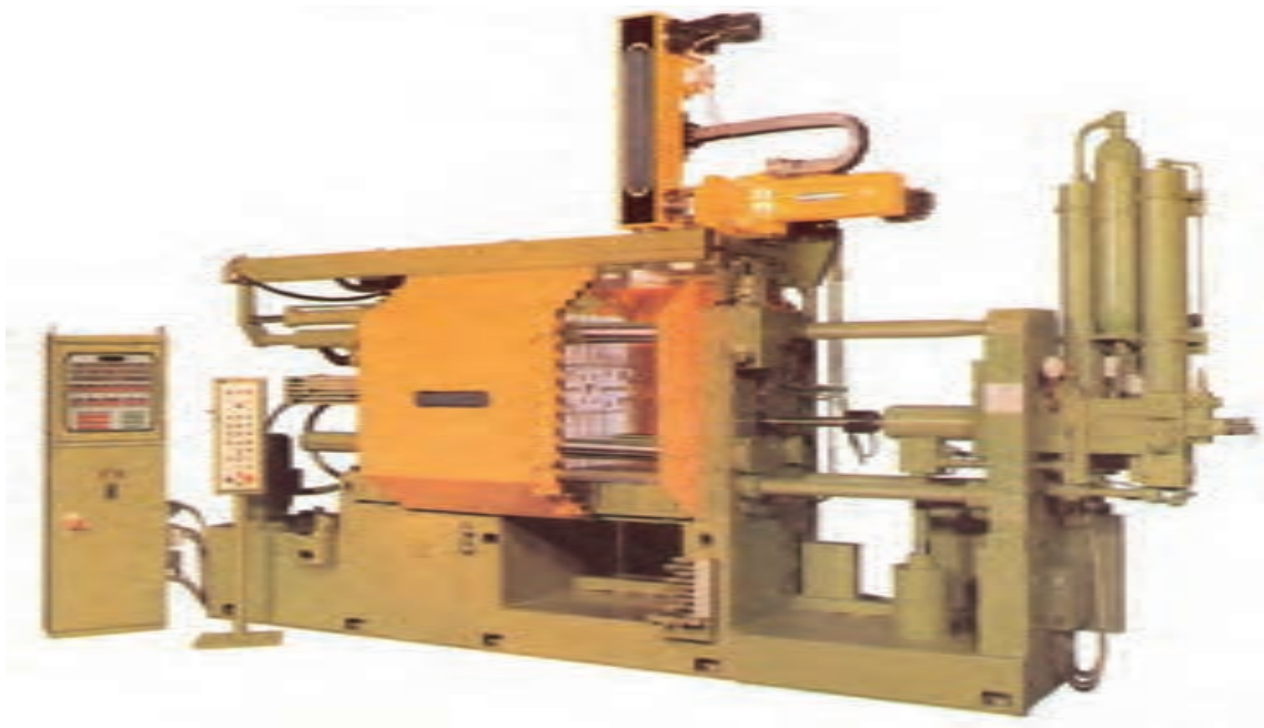
شکل ۲۶-۳- ماشین ریخته‌گری تحت فشار با محفظه سرد
