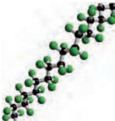
شکل ۱۷-۲- بخشی از یک مولکول پلیمری (تفلون)
