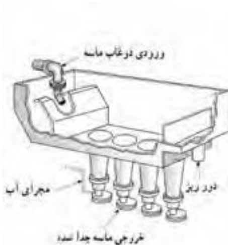
شکل ۳۷-۳- سیستم جداکننده هیدرولیکی در احیای ماسه به روش تر
