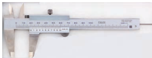
شکل ۵-۱ - کولیس ورنیه
