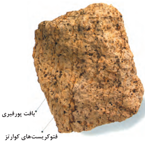
شکل ۲-۲۵- سنگ نفوذی با بافت پورفیری
