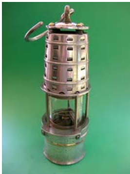
چراغ سنجنده مقدار اکسیژن در معدن
