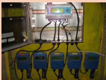
دستگاه‌های سنجنده گاز درون معدن
