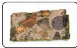
۳- نمونه برش خورده جهت تهیه مقطع
