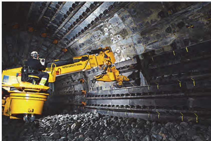
نحوه تعویض آسترهای دستگاه آسیا
