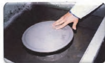
۷- برش دادن و صیقل دادن نمونه جهت کاهش ضخامت
