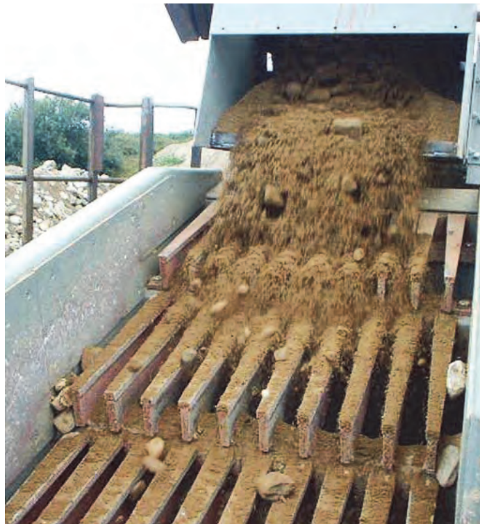
فیدر (تغذیه‌کننده) و سرند گریزلی سنگ‌شکن فکی
