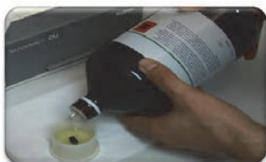
۵- قرار دادن نمونه در رزین
