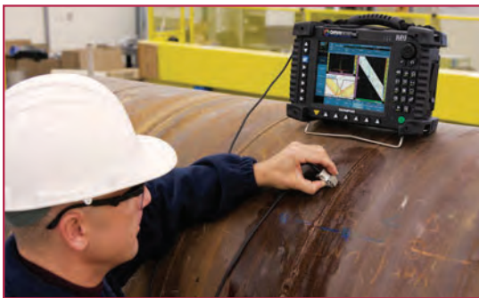
شکل ۶-۱- بازرسی جوش (تست التراسونیک)
