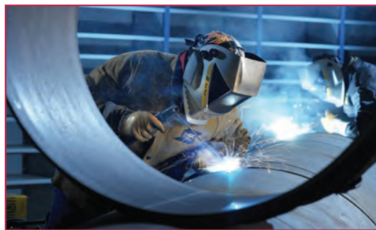
شکل ۵-۱- جوش کاری مخزن فولادی
