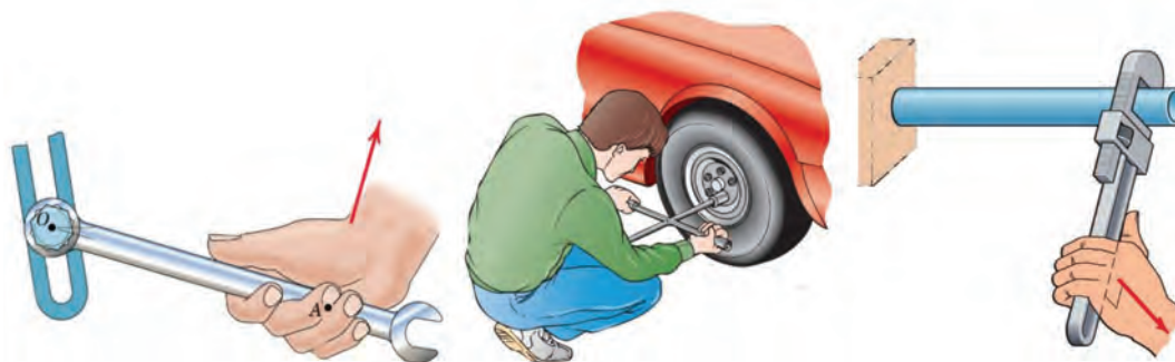
شکل ۲۷-۵- روش‌هایی برای پیچاندن قطعه
