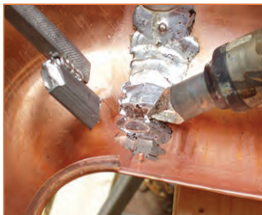
ب - لحیم کاری دو قطعه مسی
