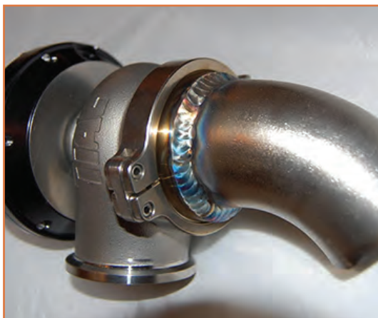
الف - جوش کاری دو قطعه فولادی
