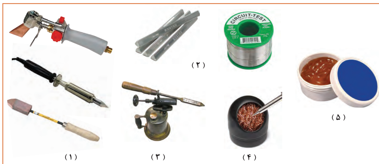
شکل ۴- تجهیزات و مواد مصرفی لحیم کاری نرم
