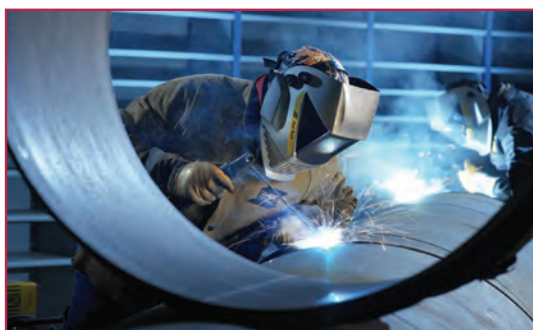
شکل ۱-۵ جوش کاری مخزن فولادی
