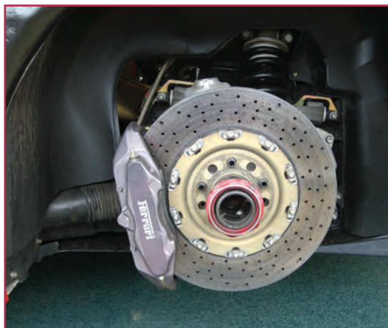
شکل ۲-۲- دیسک ترمز سرامیکی
