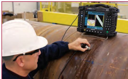
شکل ۱-۶ بازرسی جوش (تست التراسونیک)
