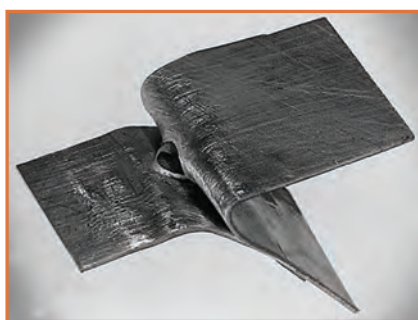
شکل ۱۹- نتیجه مطلوب در آزمون خم کاری
