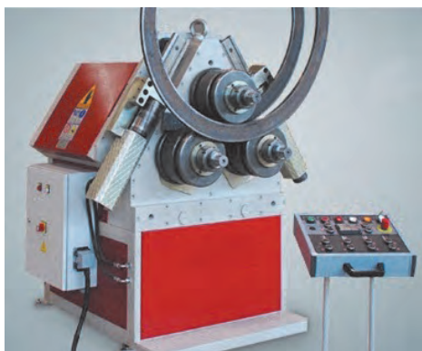
شکل ۳-۱۷- دستگاه خم کن سه غلتکی افقی
