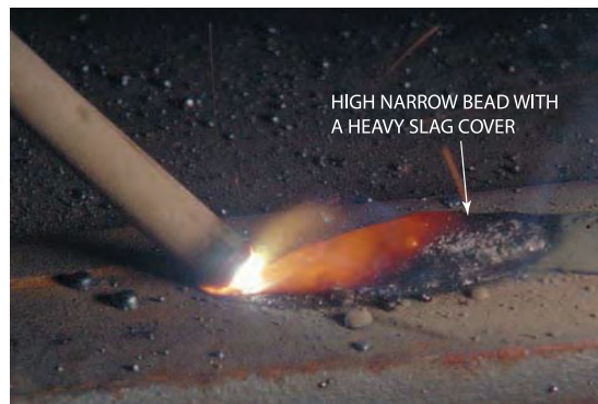
شکل ۴-۳۸: جوشکاری با طول قوس بسیار کم
