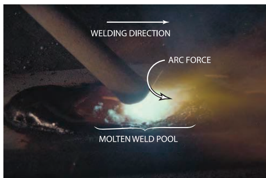
شکل ۴-۴۸: جوشکاری با زاویه پیشران
