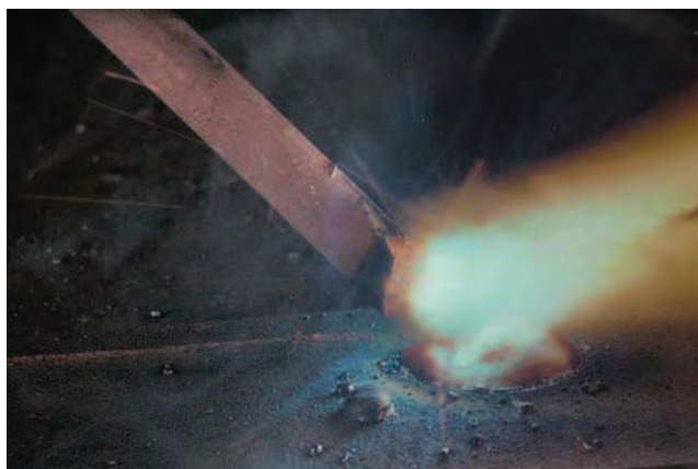
شکل ۴-۳۲: برقراری قوس با الکترودی که روکش آن کهنده شده (عدم برقرار قوس پایدار)
