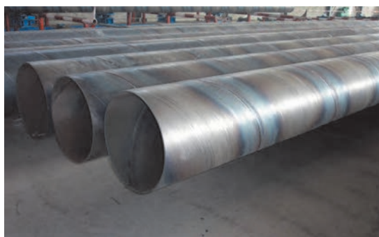
شکل ۲-۲ - لوله درزدار
