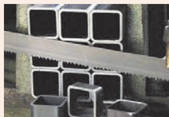
شکل ۱-۱۸- سری بری با استفاده از اره لنگ
