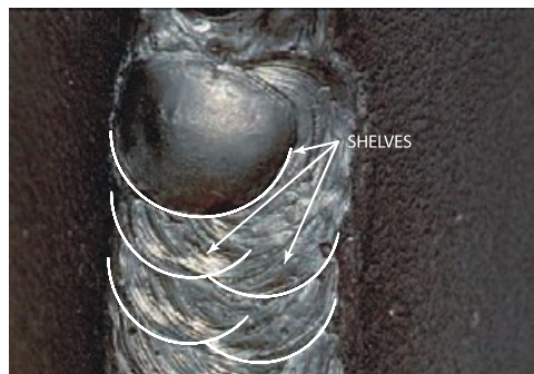
شکل ۴-۵۵- استفاده از شلف (مهره‌های بزرگ) برای محافظ از حوضچه جوش
