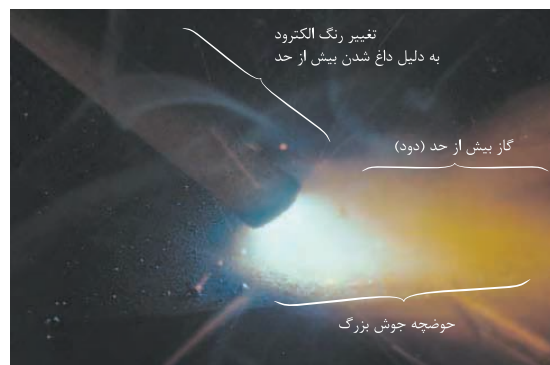
شکل ۴-۳۵: جوشکاری با آمپر بسیار بالا
