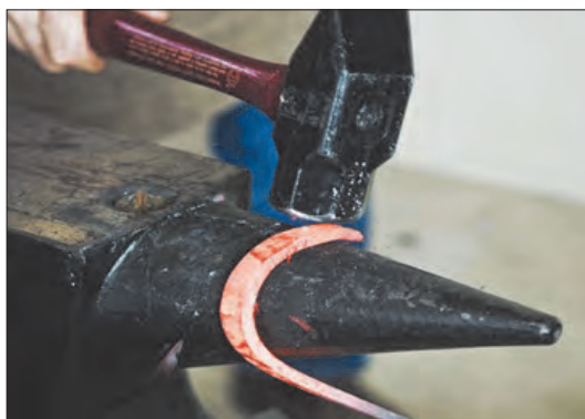
شکل ۳-۴- خم‌کاری دستی به کمک قالب و چکش
