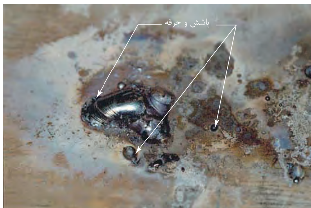
شکل ۴-۳۶: پاشش سخت شده بر روی فلز پایه
