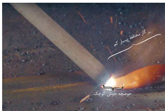
شکل ۴-۳۴: جوشکاری با آمپر بسیار پایین
