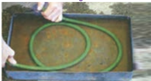
شکل ۳-۳۸- کنترل سلامت شیلنگ‌ها
