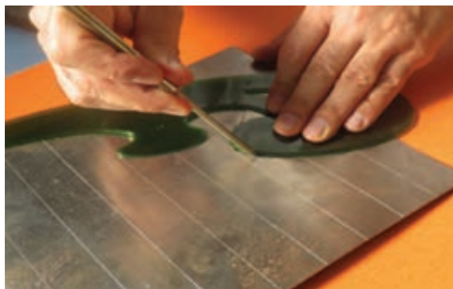
شکل ۱۱-۱ خط کشی با ورق فلزی با پیستوله
