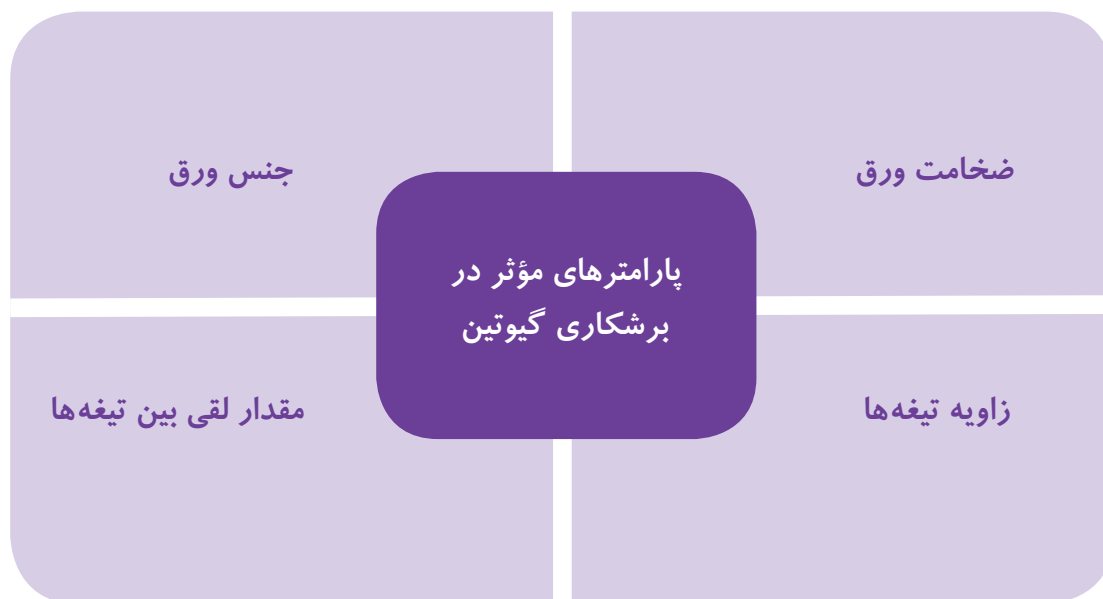
شکل ۱۰-۱- پارامترهای برشکاری با گیوتین
