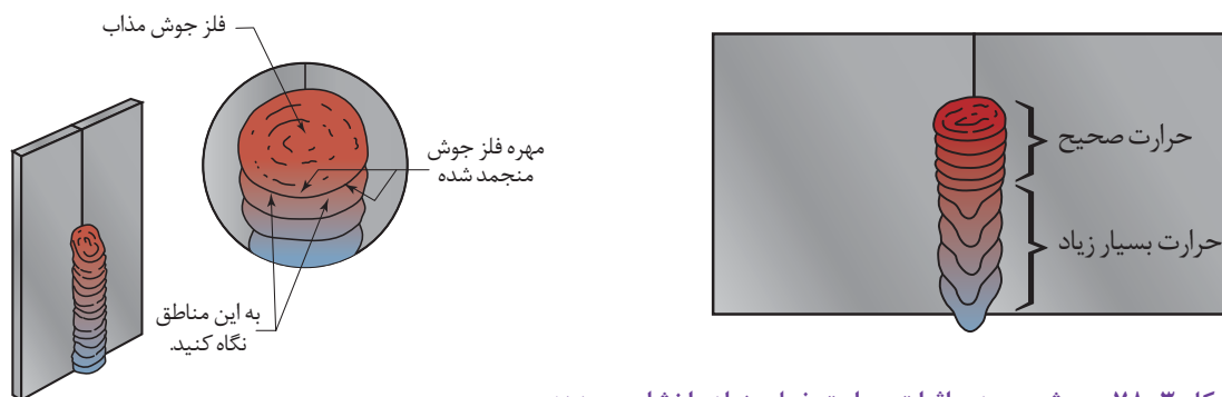
شکل ۳-۷۸- جوش عمودی اثرات حرارت خیلی زیاد را نشان می‌دهد.
