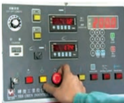
شکل ۹-۱- نمایی از صفحه تنظیمات در گیوتین CNC
