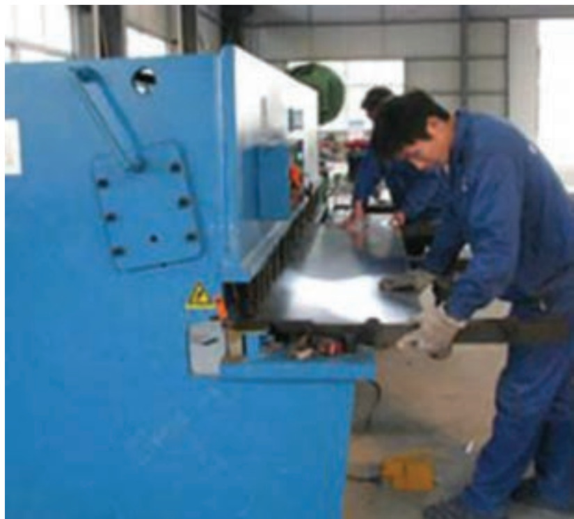
شکل ۱-۲ - برشکاری با گیوتین
