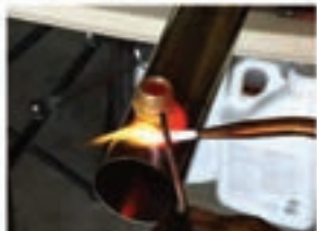
شکل (۶-۱۸) استفاده از شعله اکسی استیلن
