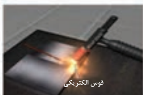
شکل (۶-۱۷) استفاده از قوس الکتریکی
