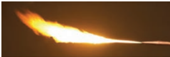
شکل ۳-۳۹ شعله احیا قوی (کربن ده)
