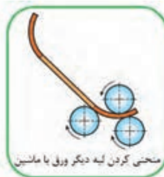
شکل ۷-۲ مراحل رول کاری با دستگاه نورد صاف کننده ساده
