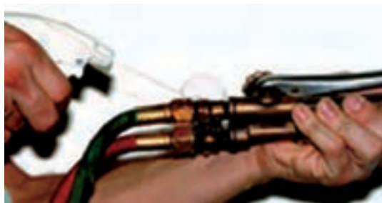
شکل ۳-۳۷- اسپری کردن محلول نشتی‌یاب روی اتصالات
