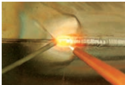
شکل ۳-۵۱- جوشکاری به روش پیش‌دستی
