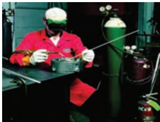
شکل (۶-۱) تجهیزات و فرایند زرد جوش
