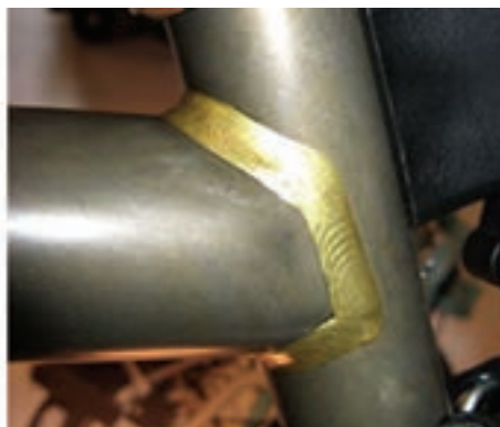
شکل (۶-۲) نمونه از جوش‌های ایجاد شده توسط فرایند زرد جوش
