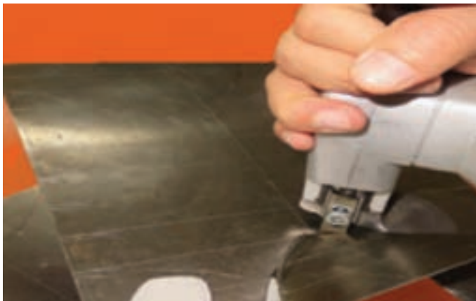
شکل ۱-۸- روش برش‌کاری با نیبلر دستی
