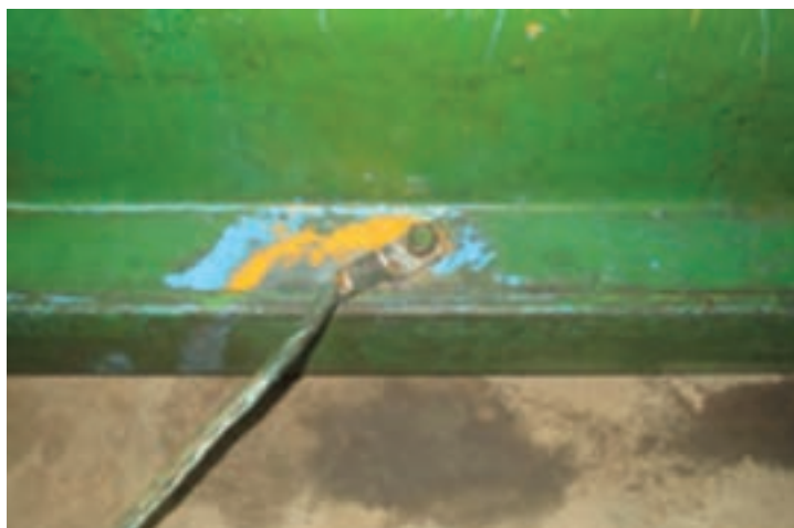
شکل ۲۳-۱- نمونه‌ای از سیم ارت در گیوتین
