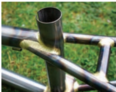
شکل (۶-۲) نمونه از جوش‌های ایجاد شده توسط فرایند زرد جوش
