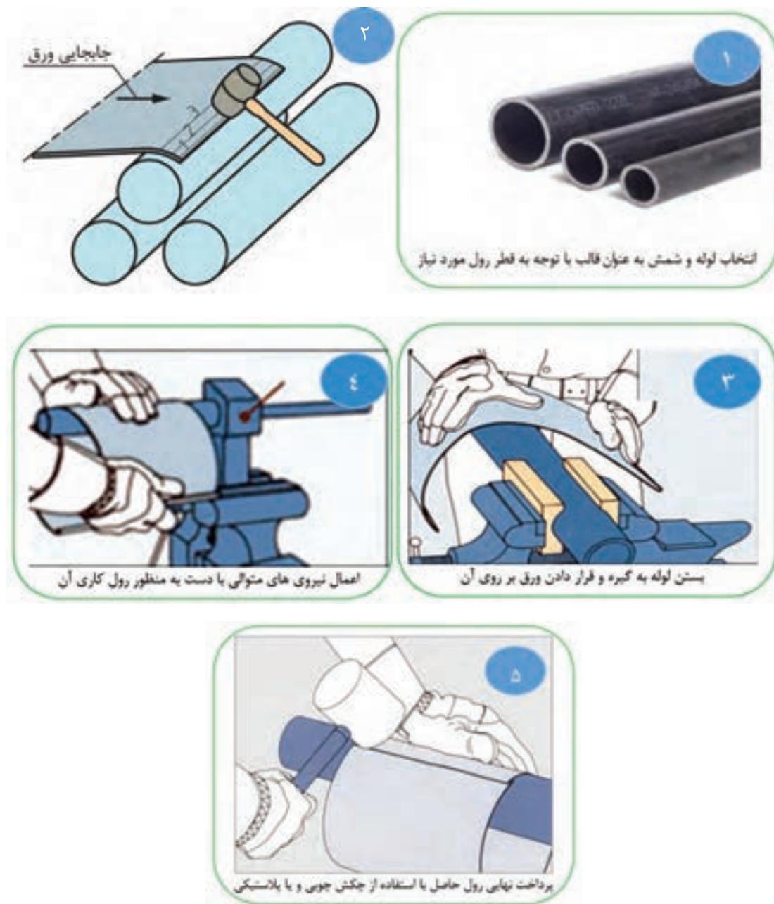
شکل ۲-۲ مراحل رول کاری با نیروی دست
