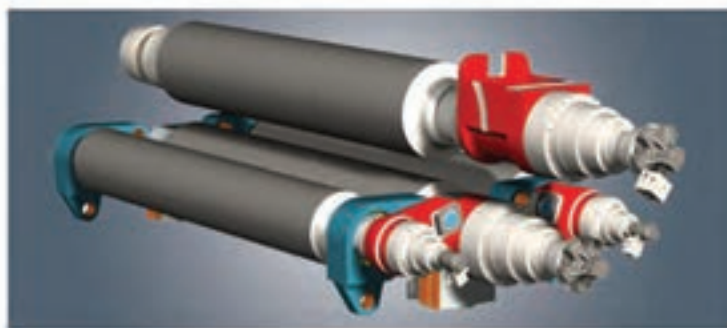
شکل ۹-۲ نمایی از نحوه قرارگیری غلتک‌ها در نورد صاف کننده چهار غلتک
