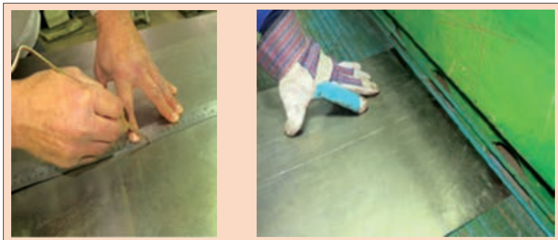
شکل ۱۴- خط کشی و برش کاری ورق فولادی با گیوتین
