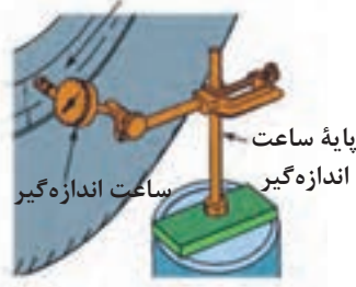
شکل ۱۸- کنترل تغییر شکل تایر و رینگ
