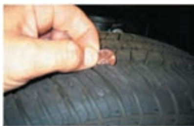
شکل ۱۷- نحوه اندازه‌گیری تقریبی شیار تایر
