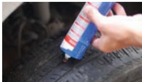
شکل ۲۷- مراحل پنچرگیری تایر بدون تیوب
