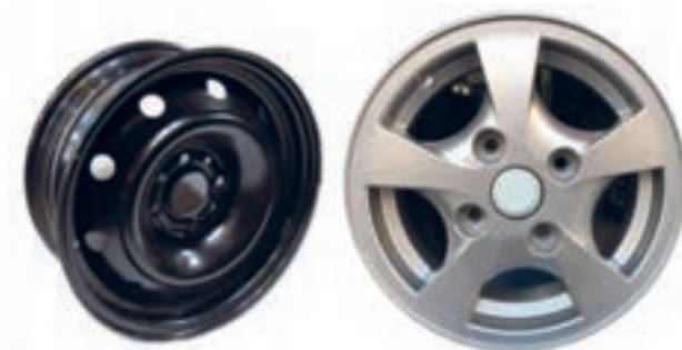
شکل ۱۰- رینگ آلومینیومی و فولادی
