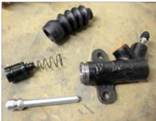
شکل ۲۴-۱- اجزای سیلندر اصلی کلاچ
