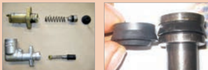
شکل ۲۱-۱- الف) نشتی داخلی در مدار هیدرولیکی
