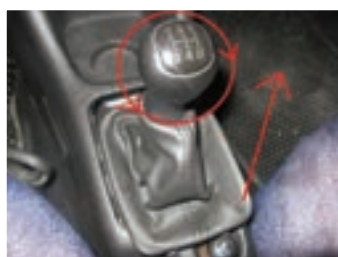
شکل ۲-۲۳- تعویض گردگیر دسته دنده
