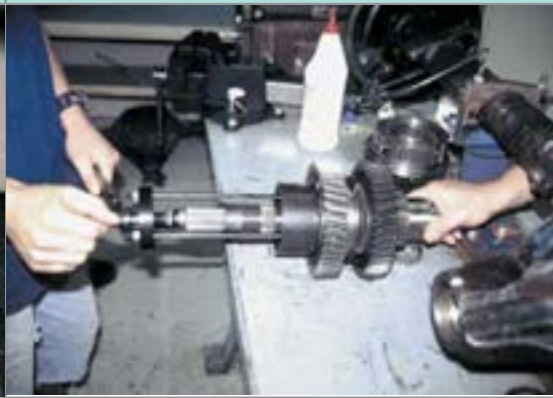
تفکیک اجزای مجموعه جعبه دنده از روی محورها با کمک پرس و ابزار مخصوص
