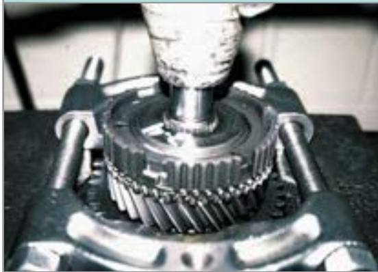
تفکیک اجزای مجموعه جعبه دنده از روی محورها با کمک پرس و ابزار مخصوص
