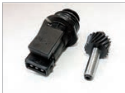
شکل ۲۰-۲ حسگر سرعت خودرو روی جعبه‌دنده
