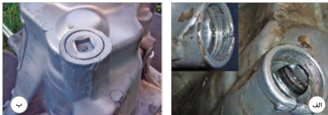
شکل ۳۲-۲ پوسته جعبه دنده و نحوه ترمیم آن
