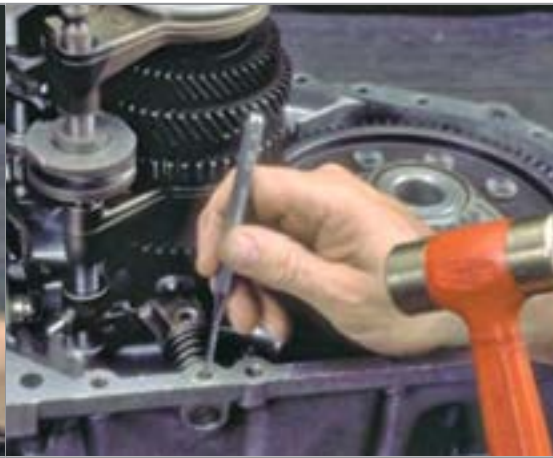
خارج کردن پین نگهدارنده اهرم تعویض دنده
